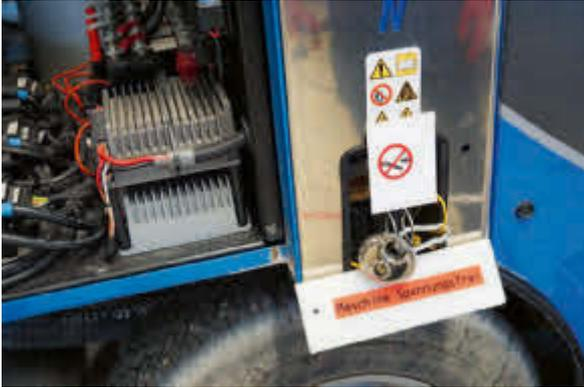
▲ Ce véhicule est correctement et clairement signalé comme étant mis hors tension et un cadenas le protège contre toute remise sous tension.
