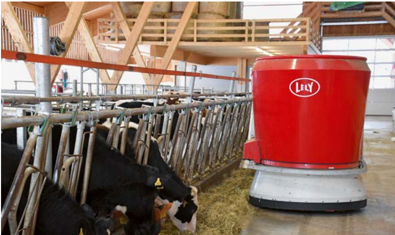
▲ GEA: Le wagon d'alimentation F4500 se déplace de manière autonome entre les bunkers de nourriture et l'étable.
