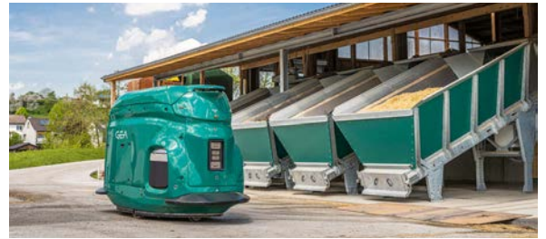
▲ GEA: Le wagon d'alimentation F4500 se déplace de manière autonome entre les bunkers de nourriture et l'étable.
