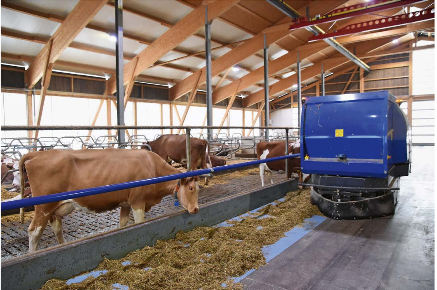
DeLaval : Le wagon de distribution au sol pousse également l'alimentation.
