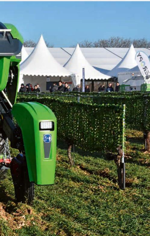
sind bereits 70 im Einsatz. Das autonome, solargetriebene Gerät speichert die exakte Position des Saatguts in der Reihe und bekämpft das Unkraut zwischen und in den Reihen.
