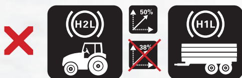
Kombination von neurechtlichem H2L Traktor ohne Erkennung und altrechtlichem H1L Anhänger
