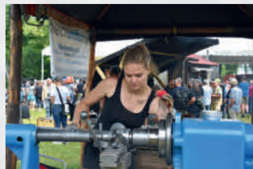
Sina Gisler demonstriert das Umformen von Aluminiumblech.
