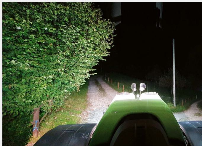
Grossflächige Ausleuchtung mit dem Super-Breitstrahler, einem LED-Arbeitsscheinwerfer von Oledone (Artikel WDOB060)
