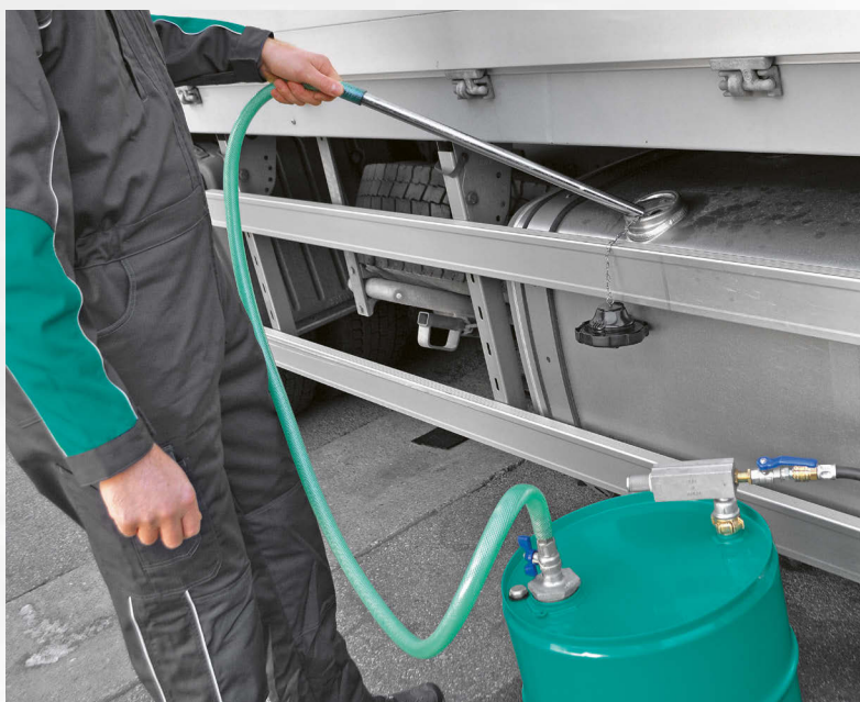
Reinigung und Aussaugen eines Dieseltanks. (Quelle Motorex AG, Langenthal)
