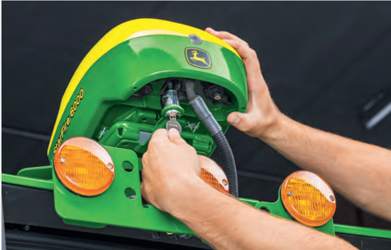
Teures Zubehör am Traktor soll durch mechanische Schlösser gesichert werden. Les équipements coûteux du tracteur doivent être protégés par des serrures mécaniques.
