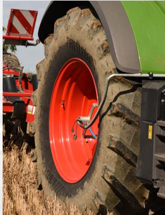
Mehr Traktion durch geringeren Luftdruck
