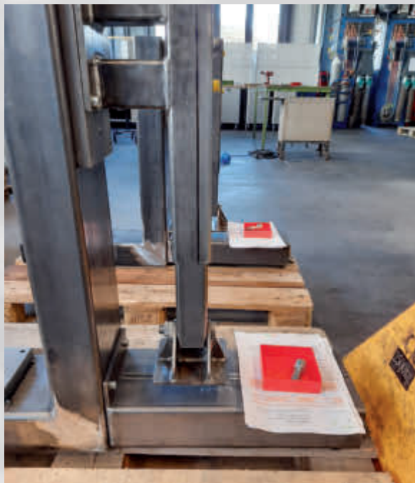
Prüfungsstück «Stützfuß» im Bereich Komponenten umbauen und anpassen.
