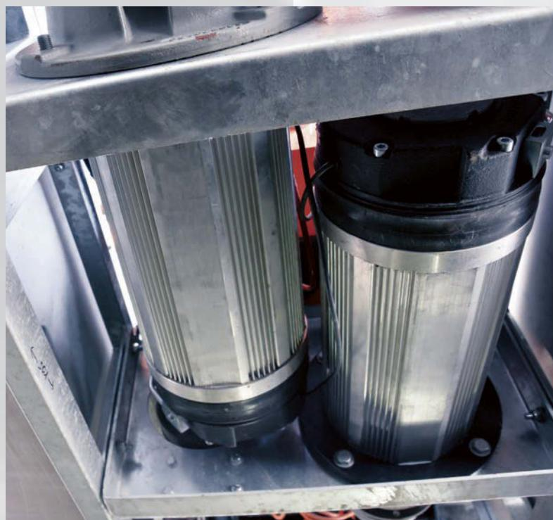
Die zwei Elektromotoren treiben die Hinter- und die Vorderachse an.
