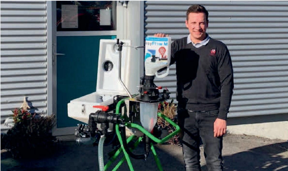
Raphael Lüdi mit der Befüllstation von der U. Wyss AG mit Einspülschleuse und dem Easy Flow M von Agrotop.
