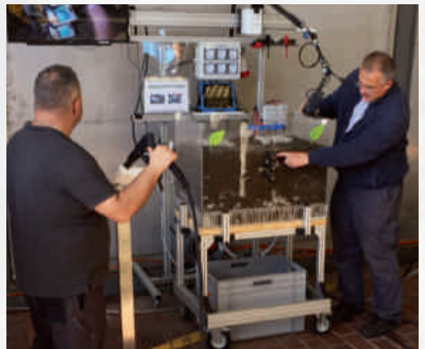
Walter Kradolfer, Firma Kränzle AG, zeigt die Wirkung der Unkrautbekämpfung mit Heisswasser am Modell.
