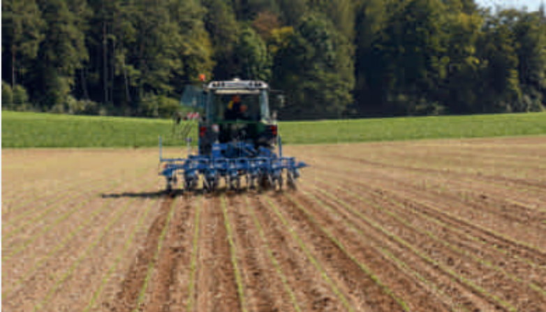
Sensorgesteuertes Hacken zwischen den Reihen mit Kamerasteuerung. Binage entre les rangs grâce à des capteurs et un pilotage par caméra.
