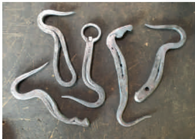
Prüfung für Lernende des 3. und 4. Lehrjahres: Alnarp Shoe und Hufkratzer aus einem alten Hufeisen. (Bild Vorbereitungsanlass in Aarberg)
