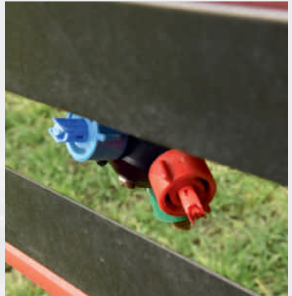
Die Luftunterstützung Airflow+ bei den Düsen erlaubt sehr gezieltes Spritzen.
