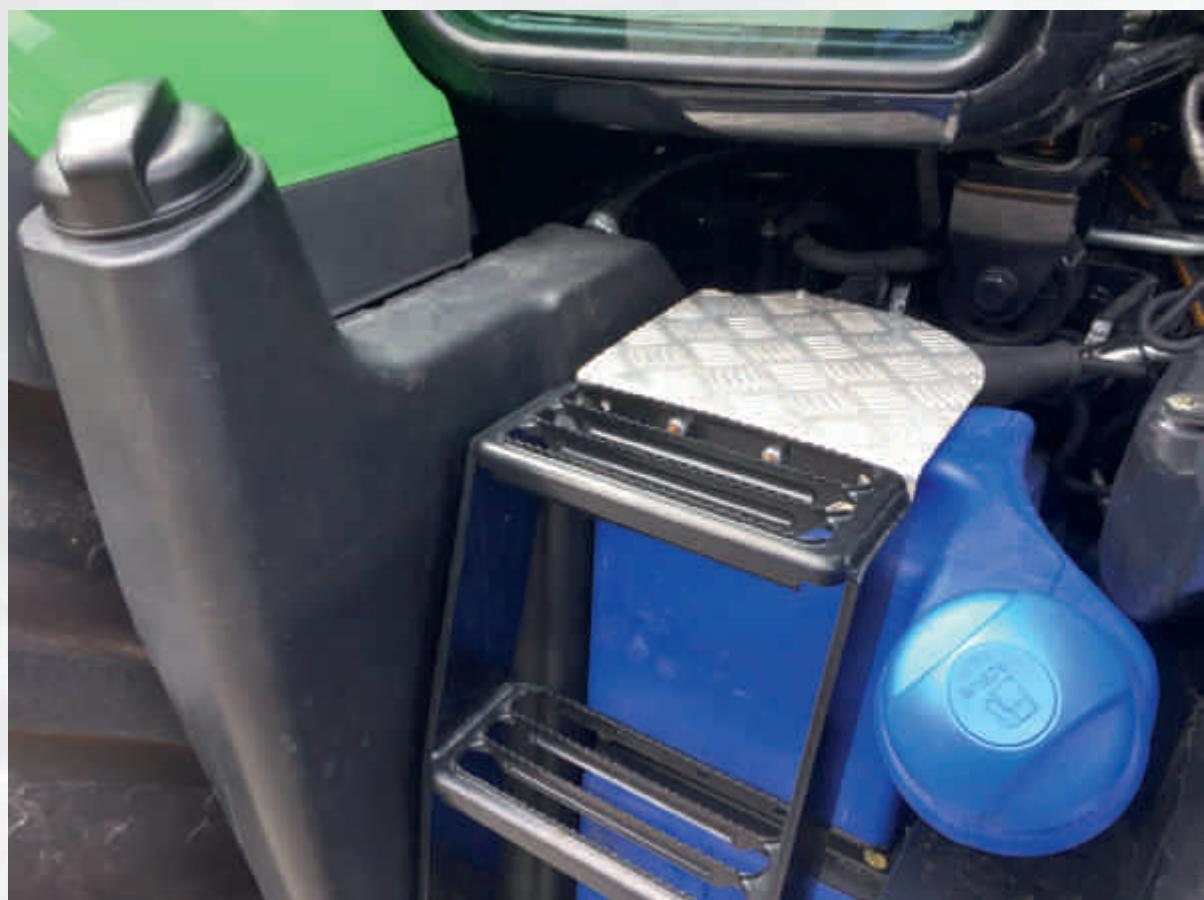
Das AdBlue muss in einem separaten Tank mitgeführt werden.
