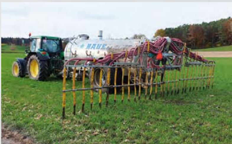
Schleppschlauchverteiler: Die Geräte werden grösser, technisch komplexer, teurer und werden zunehmend überbetrieblich eingesetzt.
