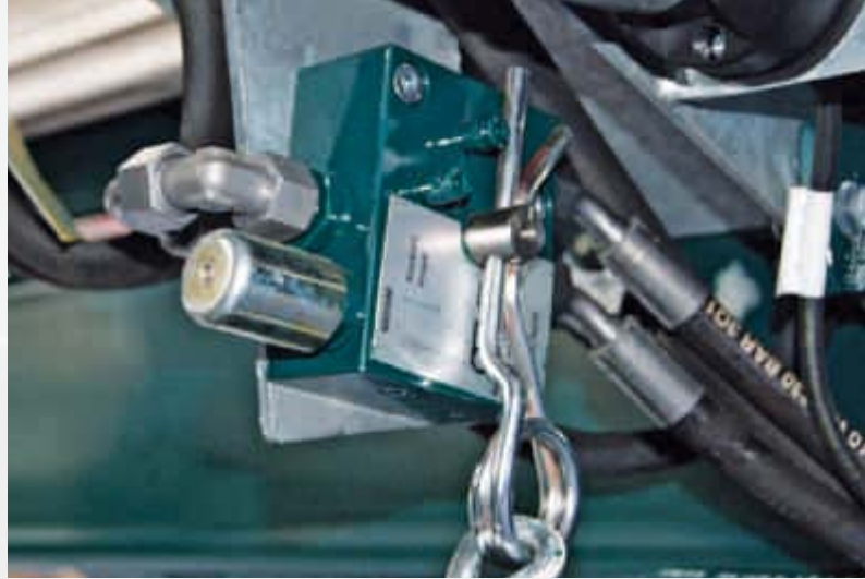
Mechanisches selbsttätiges Bremsventil, erfüllt nur das gesetzliche Minimum, bietet aber keine zusätzliche Sicherheit (Notbremse).
