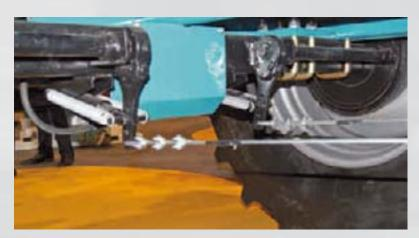
Sowohl an der AGRAMA 2012, sowie auch an der SIMA 2013, werden Hydraulikzylinder immer noch mit der Feststellbremse herausgezogen. Dadurch kann Luft in das System gelangen und die Bremswirkung ist nicht mehr gegeben.
