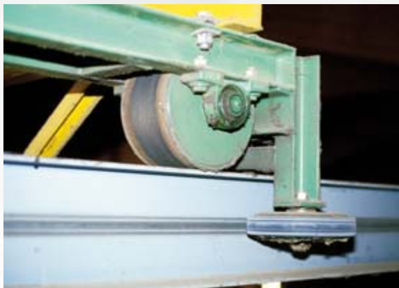
Lauf-, Trag- und Führungsrollen unterliegen einem Verschleiss. Dieser muss von den Greiferfachpersonen bei den Inspektionen überwacht werden.
