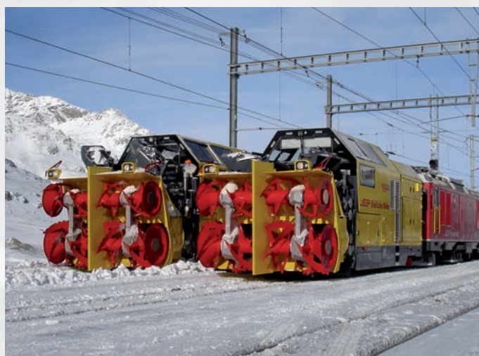
Sie sind je 30 Tonnen schwer und jede fräst an der Bernina pro Stunde 8500 Tonnen Schnee weg.
