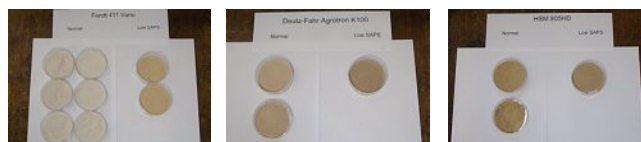
Abbildung 5: Ergebnisse des Feldversuchs mit einem aschearmen Motorenöl. Die Aschemengen konnten durch den Einsatz des Low-SAPS Motorenöl um rund 50 % gesenkt werden. Die Bilder zeigen die Aschemengen jeweils links mit normalem Motorenöl, rechts mit aschearmem Öl (Low SAPS Öl).
