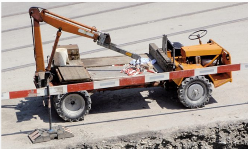
Kat. C, da weniger als 400'000 Nm (40 t/m) und 1'000 kg an der Seilwinde.
