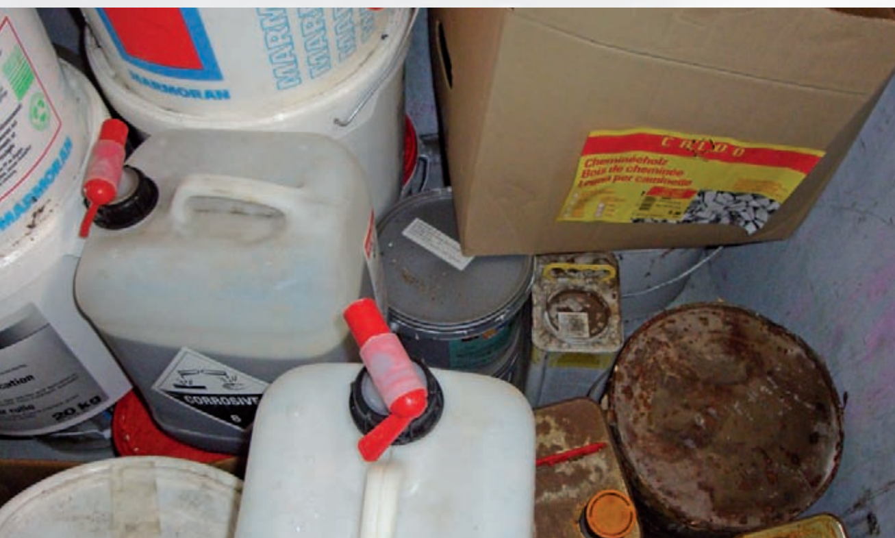
Schlechtes Beispiel: Hier werden feuergefährliche Stoffe wild durcheinander zusammen mit Holz gelagert. Es fehlt eine klare Ordnung und Kennzeichnung. So besteht eine grosse Brandgefahr.
