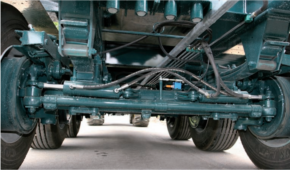
Gelenkte Nachlaufachse mit Positionssensor für die Rückmeldung an die Elektronik.
