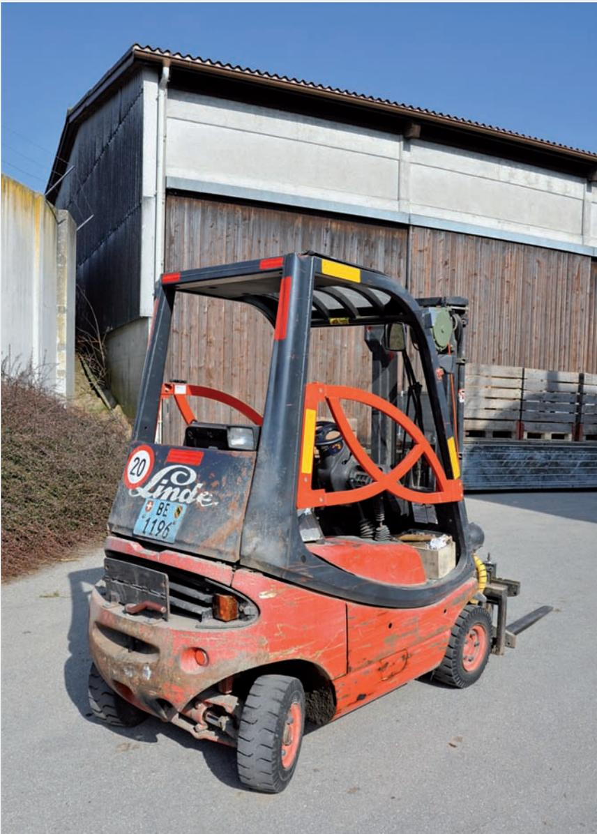
Bei Staplern, welche im Gewerbe eingesetzt werden, muss schon seit Jahren ein Fahrerrückhaltesystem vorhanden sein (Bügeltüren, Türen oder Gurt).
