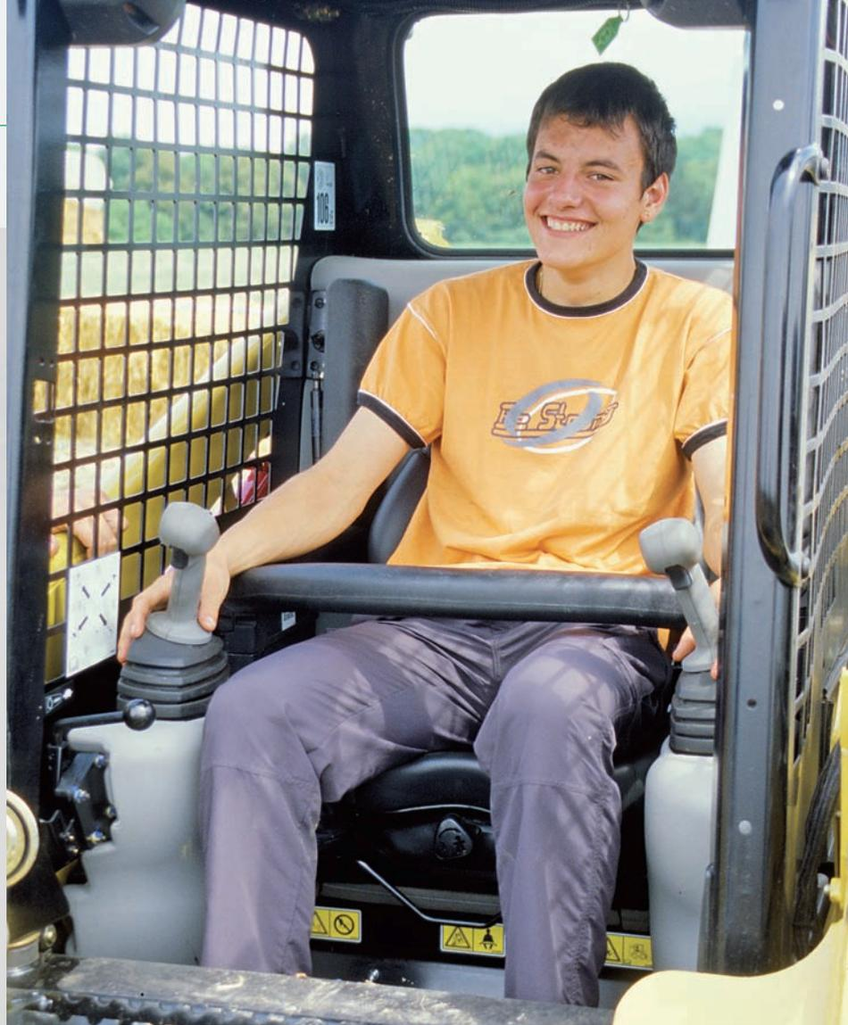
Bei Kompaktladern wie von Bobcat werden zum Festhalten des Fahrers schon seit längerem solche Klappbügel eingebaut.
