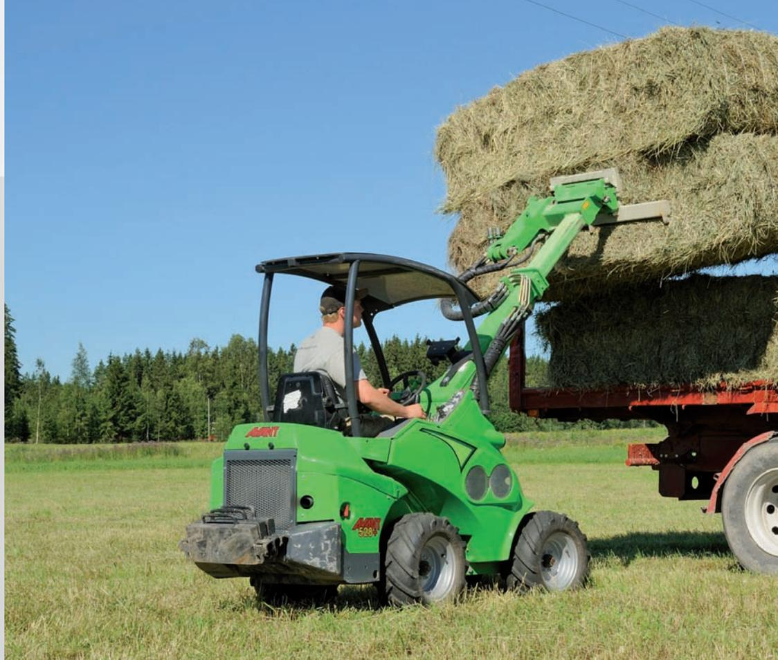
Les chargeurs de fabrication Avant sont déjà équipés d'une structure FOPS. Le dispositif de retenue du conducteur est constitué d'une ceinture neutralisant la transmission via un contact de siège couplé en série.
